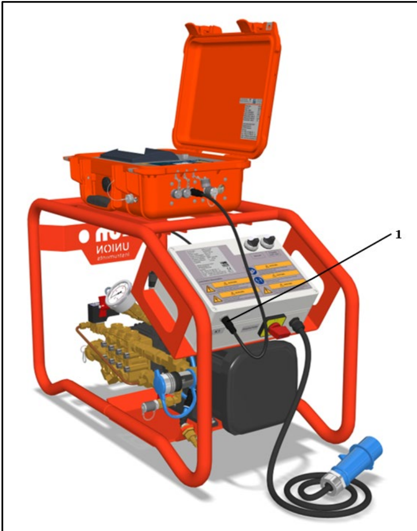
Abb. 7.2: Anschluss Dichtheitsprüfkoffer "PMS"
